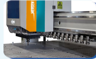
KÖPRÜ ALTI SIRALI TAKIM DEĞİŞTİRME AUTOMATIC TOOL CHANGING UNDER THE BRIDGE
